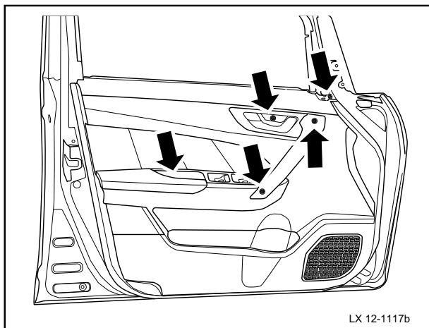
4 安装并紧固左前车门内装饰板的5个螺钉。
