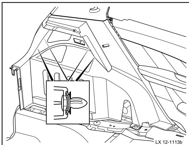
1 将后柱下装饰板背面卡扣对准安装孔，按压装饰板扣紧卡扣。
