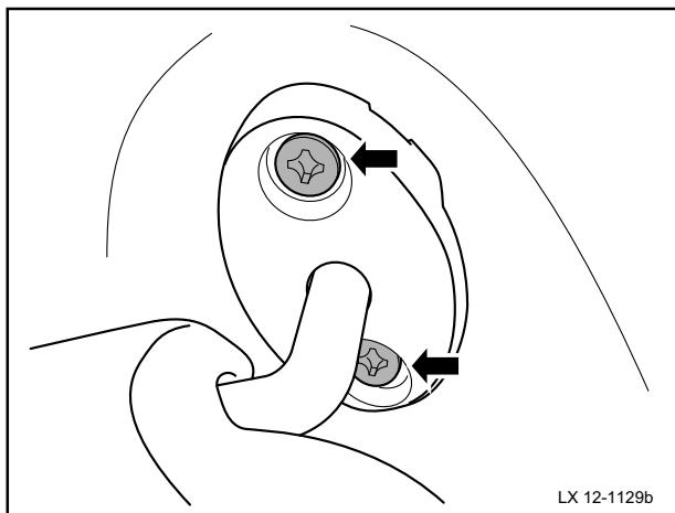
7 安装右侧遮阳板并紧固2个固定螺栓。
