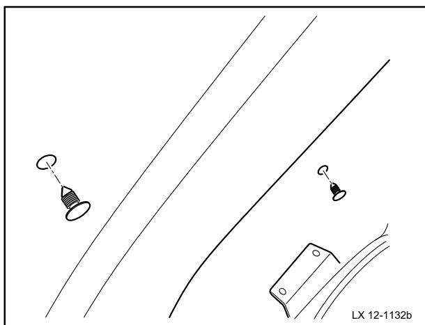
4 安装顶盖内装饰板后部的2个固定卡扣。
