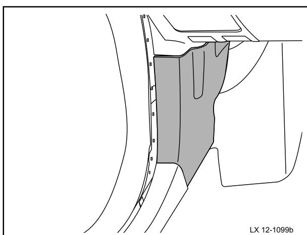
4 安装并紧固前柱下装饰板总成固定螺母。
