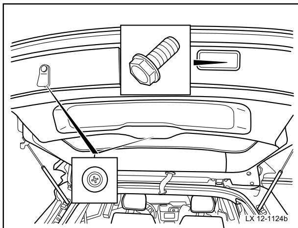
8 拆下背门下内饰板上的1个固定螺钉和2个固定卡扣
