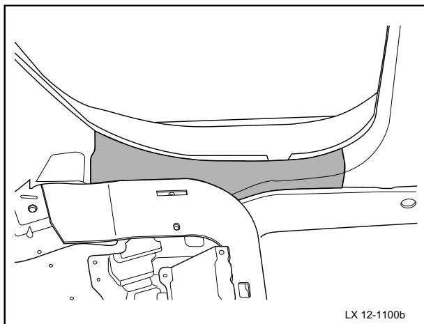
1 将后门槛内装饰板的1个固定卡扣对准安装孔，按压装饰板使卡扣扣紧。
