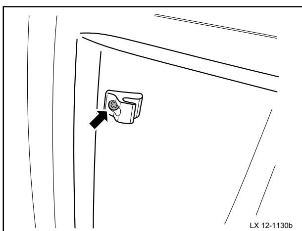
10 拆卸右侧遮阳板挂钩固定螺栓，取出遮阳板挂钩。左侧遮阳板拆卸程序与此相同。
