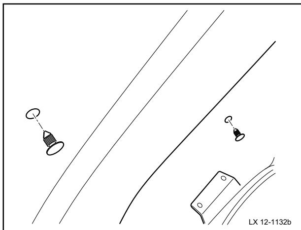
12 拆卸顶盖内装饰板后部的2个固定卡扣。
