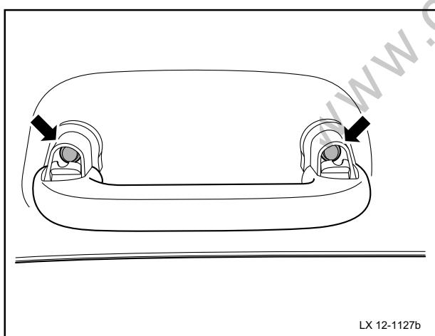
9 安装并紧固右前安全拉手的2个固定螺栓
