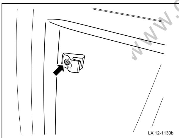
6 安装并紧固右侧遮阳板挂钩的固定螺栓。
