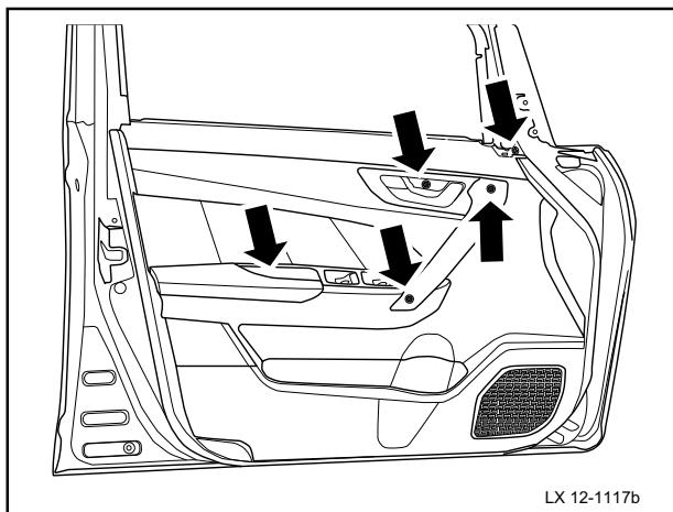
5 拆卸左前车门内装饰板的5个固定螺栓
