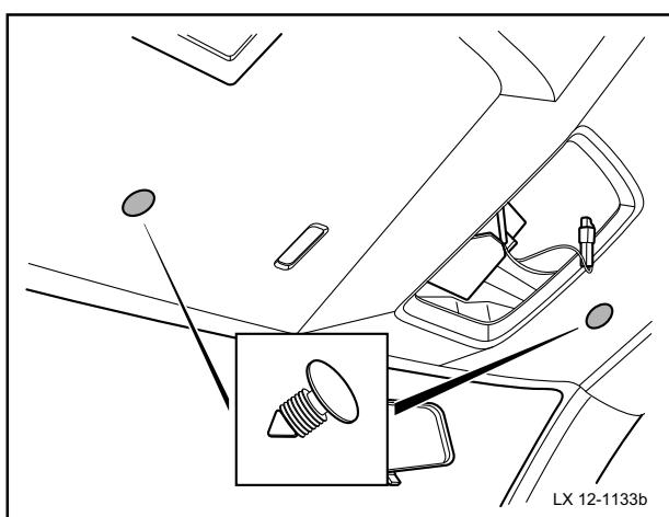
13 拆卸顶盖内装饰板前部的2个固定卡扣
