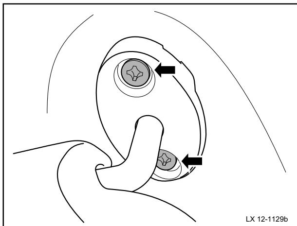
9 拆卸右侧遮阳板的2个固定螺栓，取下右侧遮阳板。
